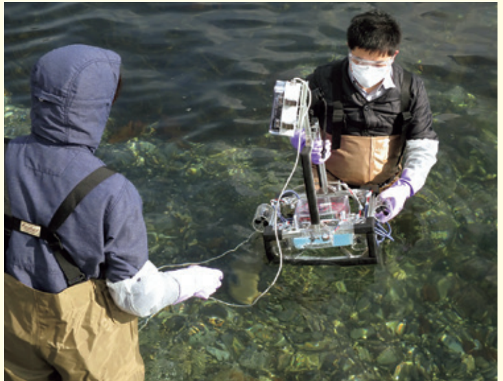
水中カメラ・水中ライトを取り付けた水中ロボットの海での実験の様子
