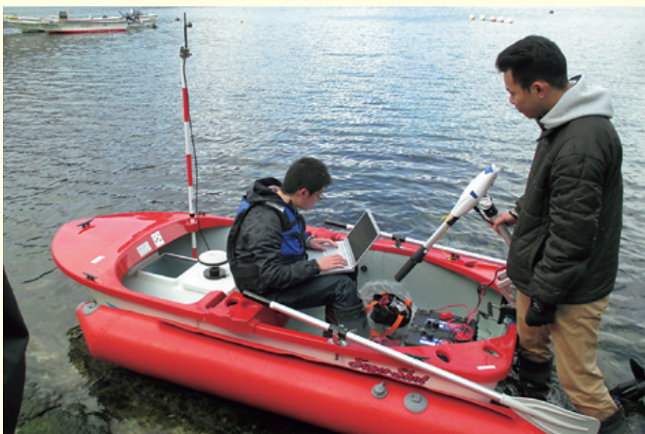
大船渡市越喜来湾で高精度GPSを用いた自動操船評価実験
